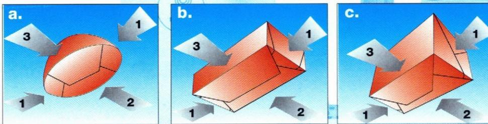
Bei der Verwendung einer Heißsiegelstation (Sonderzubehör) können die unter b. und c. gewickelten Schokolade-Artikel auch in heißsiegelfähigen Folien und Kunststoffen verpackt werden. Dabei kann eine separate Folie untergelegt werden. Hierzu wird die Maschine mit einer doppelten Folienabwicklung ausgerüstet.
